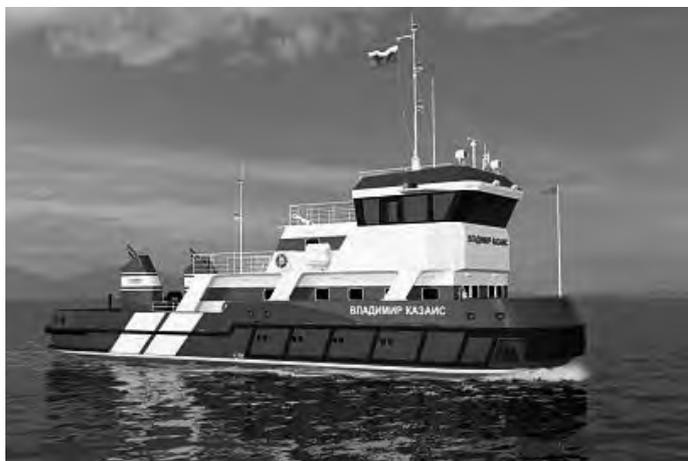
Технические характеристики буксира: длина габаритная 30 м, длина наибольшая 29,6 м, ширина наибольшая 8,2 м, высота борта на миделе 3 м, осадка максимальная в полном грузу не более 1,1 м, водоизмещение буксируемых плавсредств не более 1000 тонн. Класс Российского классификационного общества (РКО) М3,0 (лед30)А.
