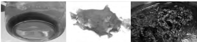
Рис.2. Нарушение стабильности топлив VLSFO
