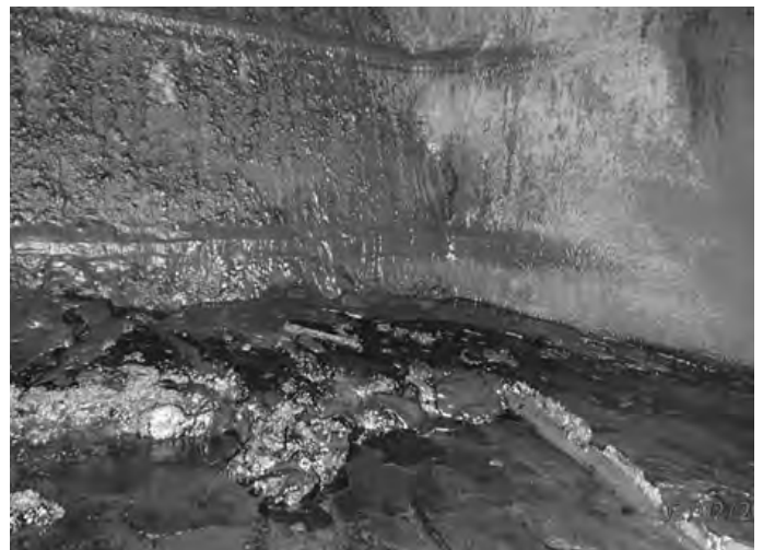
Рис.3. Выпадение парафинистого шлама из топлив VLSFO
