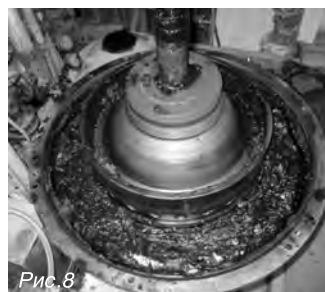
Рис.8. Вид сепаратора через 3 ч после подачи нового топлива типа VLSFO
