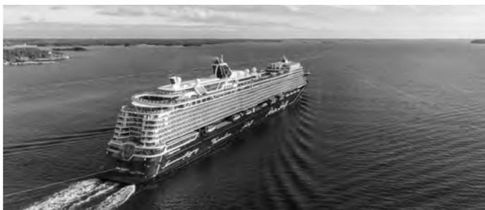
Mein Schiff 7 — это современное судно, в котором приоритетом являются экологичность и эффективность. При длине 316 метров и ширине 35,8 метра он может вместить около 2900 пассажиров и 1000 членов экипажа. Круизный лайнер будет работать на судовом дизельном топливе с низким уровнем выбросов с содержанием серы 0,1% и подключении к береговой электросети для работы в порту с практически нулевым уровнем выбросов (на что приходится 40% времени его работы).
