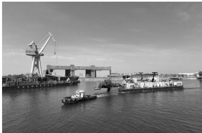
Суда предназначены для выполнения дноуглубительных работ: разработки илистых, песчаных и песчано-гравелистых грунтов, а также для очистки рек и каналов от наносов. Производительность земснарядов составляет 900 куб. м грунта в час. При свободном плавании скорость судна может достигать 12 км/ч.
