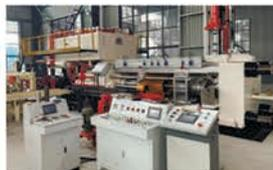
В первом квартале 2025 года в прессовом цехе «Р.О.С.Антикор» был введен в эксплуатацию экструзионный пресс мощностью 1500 тонн с максимальными технологическими возможностями.
