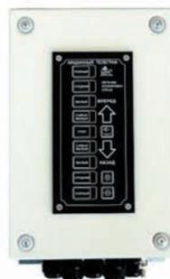
Машинный телеграф Панель МТ-1Щ
