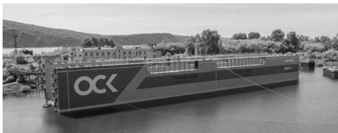
Новый док-понтон предназначен для транспортировки строящихся и ремонтируемых судов и кораблей из сухих эллингов завода к достроечному пирсу, а также для спуска судов на воду. Док-понтон строится для выполнения производственной программы Амурского судостроительного завода ОСК.
