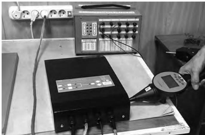
Для интуитивного, моментального восприятия режимов работы, оценки состояния входных и выходных напряжений и определения неисправности реализована мнемосхема, которая позволяет мгновенно принимать решения о состоянии БП NavCom Alfa и подключенных к нему сетей и устройств. Это чрезвычайно важно при эксплуатации, обслуживании и ремонте оборудования. Уникальная конструкция БП NavCom Alfa позволяет работать с полной нагрузкой при температуре окружающей среды до +40°C без принудительного охлаждения.
