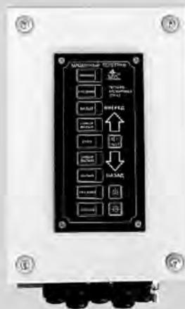
Панель машинного телеграфа цифрового исполнения МТ-1Ц
