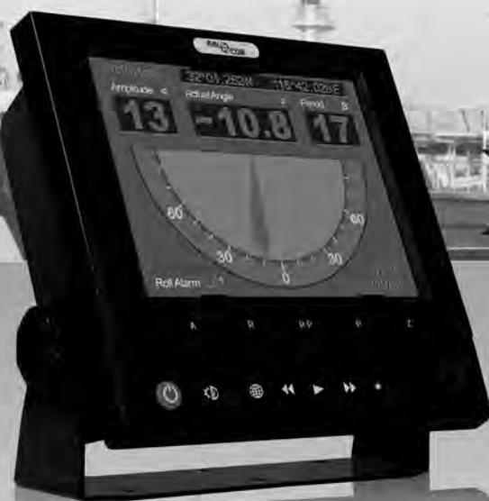
Электронный кренометр NavCom Delta 401 предназначен для поддержки процесса принятия решений на судне с целью предотвращения опасных ситуаций, а также оказания помощи и содействия проведению расследований на море посредством предоставления информации о периоде бортовой качки и угле крена судна и/или передачи информации в регистратор данных рейса (РДР).
