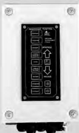
Панель машинного телеграфа щитового исполнения МТ-1Ц
