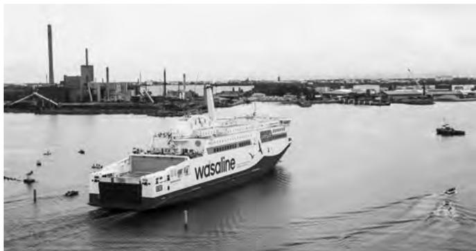
Aurora Botnia - это 150-метровый автомобильно-пассажирский паром, работающий как на СПГ, так и на биогазе (LBG), оснащенный двигателями Wartsila.
