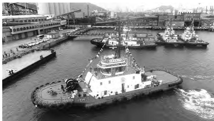
Судно оборудовано литий-железо-фосфатными аккумуляторными батареями, которые служат источником энергии. Общая расчетная мощность составляет 5000 кВтч, что позволяет буксиру развивать скорость, как у обычных буксиров.
