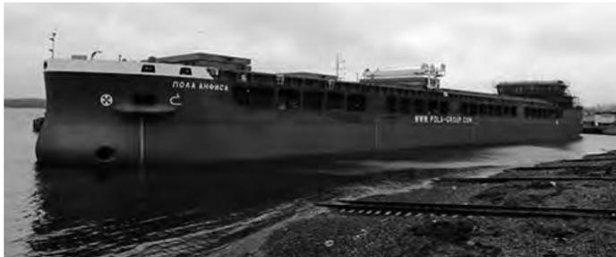
Судно предназначено для перевозки генеральных и навалочных грузов (в том числе зерна), пакетированных пиломатериалов, круглого леса, металлолома, металла в связках и рулонах, крупногабаритных, длинномерных и тяжеловесных грузов, угля, опасных грузов классов 1.4S, 2, 3, 4, 5, 6.1, 8, 9 в соответствии с МК МПОГ и Приложения В Кодексе
